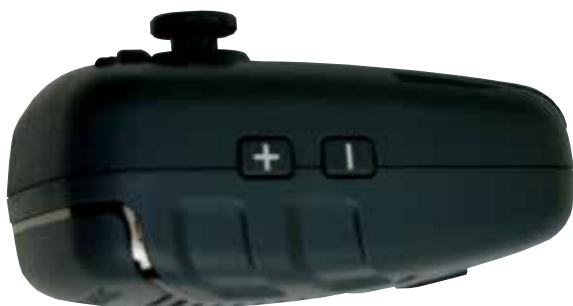
Z boku mikrofonu są zainstalowane dwa przyciski: VOL UP (+) i VOL DOWN (–) do regulacji siły głosu
